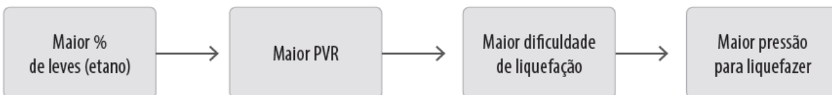
Figura I: Influência da presença de leves na qualidade do GLP
